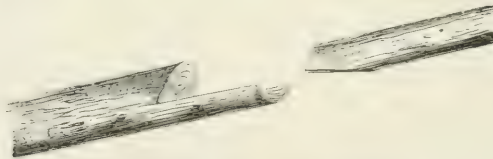
Fig. 163. Verbindung der Riesebäume.
