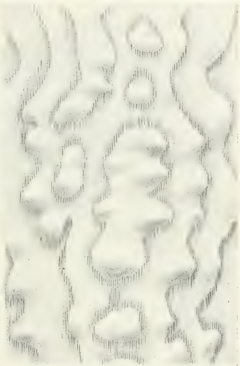
Fig. 33. Eichenholz mit welligem Faserverlauf; maserartige Struktur.
