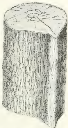
Fig. 44. Frostriß und Frostleiste; übrige Ritze am Querschnitte durch Austrocknen entstanden.
