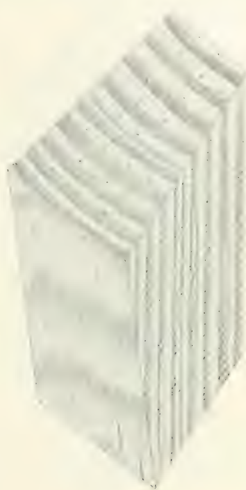
Fig. 21. Typus des Holzes der Taedaföhren, Gattung Pinus , Sektion Taeda . Pitch-Pine-Holz der Pinus palustris aus den Südstaaten von Amerika.
