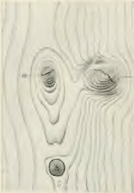
Fig. 38. Längerschnitt durch die Spiriregion eines Nadelholzbaumes; die Äste a, a in festem Zusammenhange, neben der Beeinträchtigung des Auswertes auch den Tierwert solcher Bildungen zeigend; bei b ein kleiner Zwischenaustritt, als toter Ast später bei Einordnung des Brettes herausfallend.
