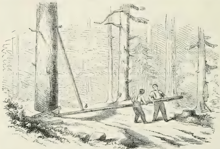
Fig. 120. Werfen des Stammes mittels Hebelstange.
