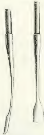
Fig. 325. Schälereisen zur teilweisen Ablösung der Rinde.
