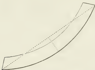
Fig. 291. Krummholz für den Schiffbau mit Bucht in der Mitte.
