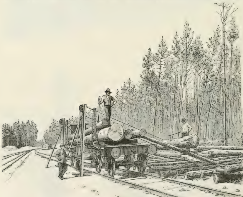
Fig. 188. Verladen der Stämme mittels der Seil- oder Kettenwinde.
