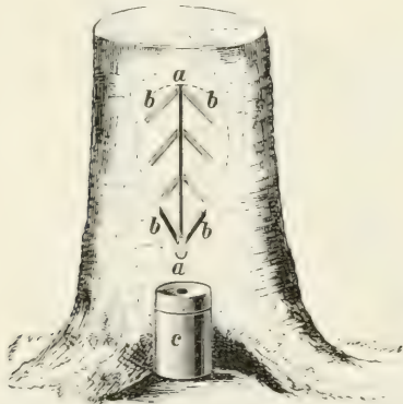
Fig. 326. Anbringen der Blechstreifen, Ausflusrrinne und des Sammelgefäßes bei einer neuen Harzungsmethode.
