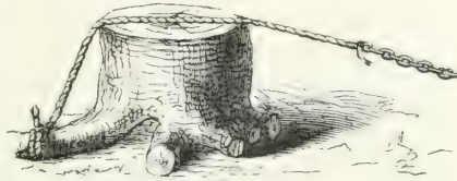
Fig. 121. Ausziehen eines angerodeten Stockes durch den Waldtenfel.
